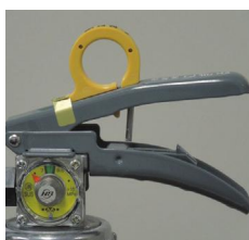
× レバー支えの脱落
