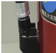
× 消火薬剤の漏れ
