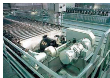
加圧脱水機 圧力を加え、泥の水分を取り除きます(これを脱水ケーキと呼びます)。
