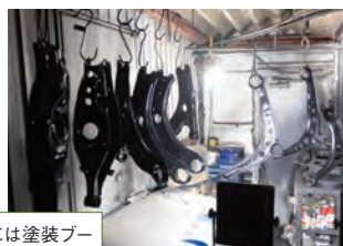
工場の一角には塗装ブースが設けられ、リビルド品を新品同様に仕上げる。
