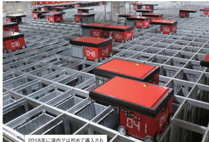
2018年に道内では初めて導入された「オートストア」。圧倒的な保管効率（同じ面積で3倍）で、ロボットが作業者の手元まで商品を運ぶ。
