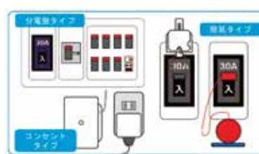
地震の揺れを感じると自動的にブレーカーを落として電気を止める感震ブレーカーを設置しましょう。
