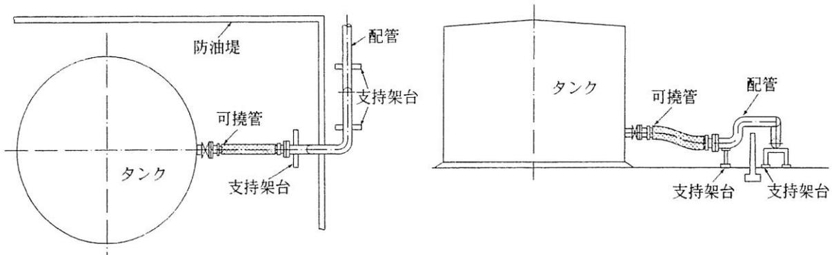
第19-2図 配管の屈曲による軸方向変位量の吸収措置例
