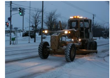
路面整正(除雪グレーダ)
