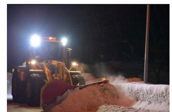
新雪除雪(除雪ドーザ)
