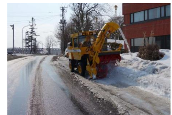
拡幅除雪(ロータリ除雪車)
