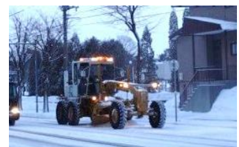
新雪除雪(除雪グレーダ)
