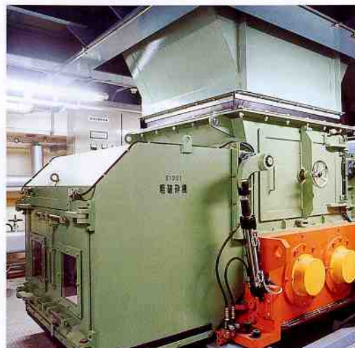
粗破碎機 不燃・粗大ごみを二軸破碎機で一次破碎し、約400mm以下の大きさにします。
