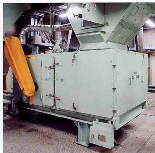
アルミ選別機 破碎したごみの中からアルミ類を選別します。
