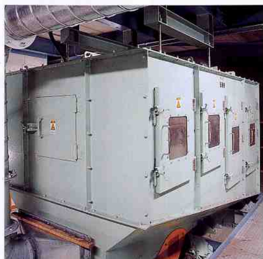
磁選機 破碎したごみの中から鉄類を選別します。
