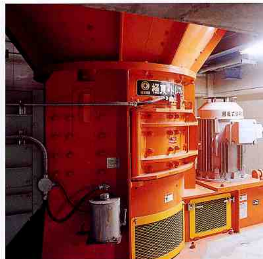
回転式破碎機 粗破碎されたごみを高速回転で効率よく二次破碎し、約150mm以下の大きさにします。
