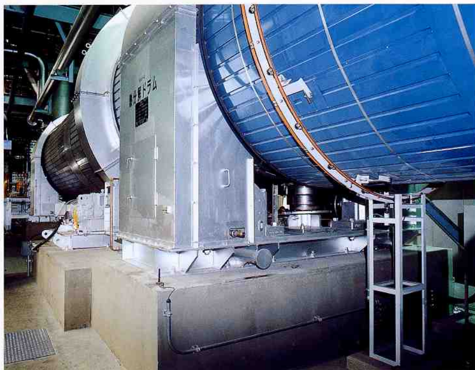
熱分解ドラム ごみを空気のない状態で約1時間、450℃で蒸し焼きにして熱分解ガスとカーボンに改質します。
