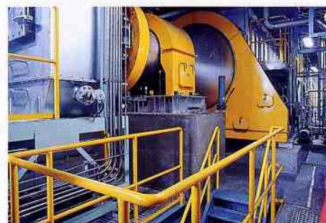
冷却ドラム 熱分解ドラムから出た約450℃の熱分解カーボンと不燃物を約80℃まで冷却します。
