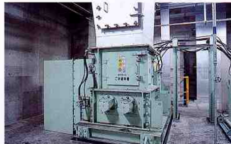
ごみ破砕機 効率よく安定した熱分解を行えるように、ごみを一定の大きさに細かく砕きます。
