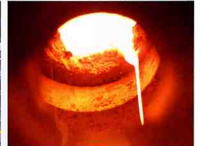
スラグホールから流れ落ちる溶融スラグ 燃焼溶融炉で灰分を溶融し、溶融スラグがスラグホールより排出されます。
