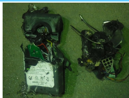
↑ 焼損した充電式電池
