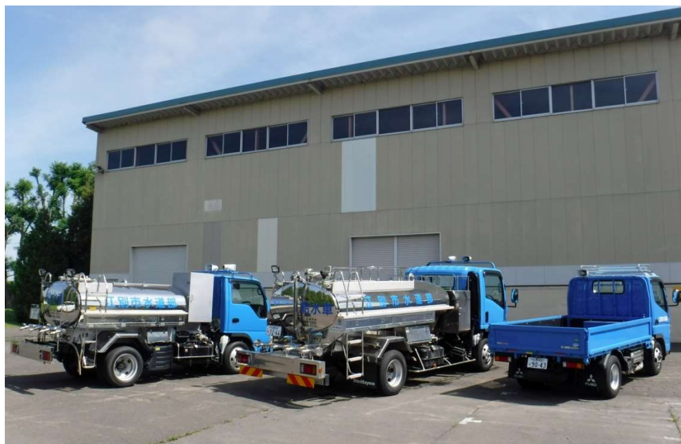
写真 3-8 【加圧給水タンク車等】
