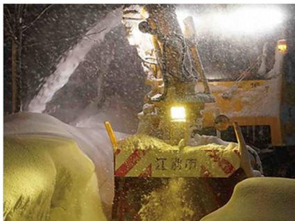
大型ロータリによる拡幅除雪の状況
