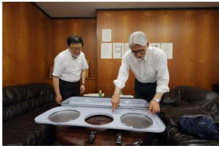
こうした技術が信号機の生産でも使われるようになっていきます。いま製造している信号機は溶接しているところが1か所もないんですよ。溶接するとステンレスでもさびてきますし、水が中に入る可能性もあります。水は絶対に入ってはいけませんから。
