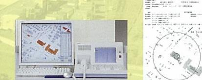
出動隊の編成が完了すると、署・出張所の出動隊に対し音声合成による指令や指令書により自動的に指令内容を伝えます。
