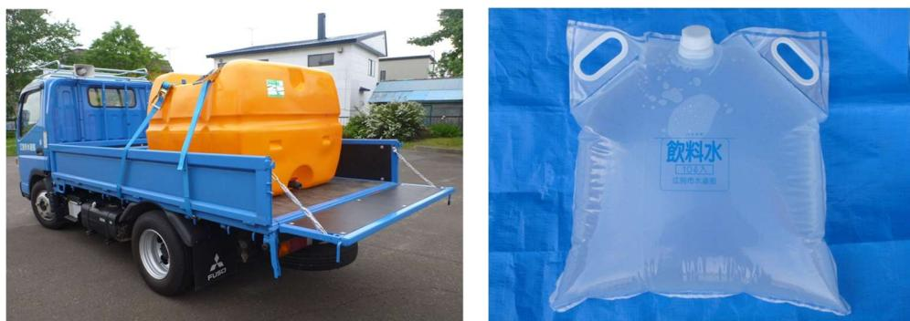
写真 7-8【車載用給水タンク（左）と 10ℓ 紙袋（右）】
