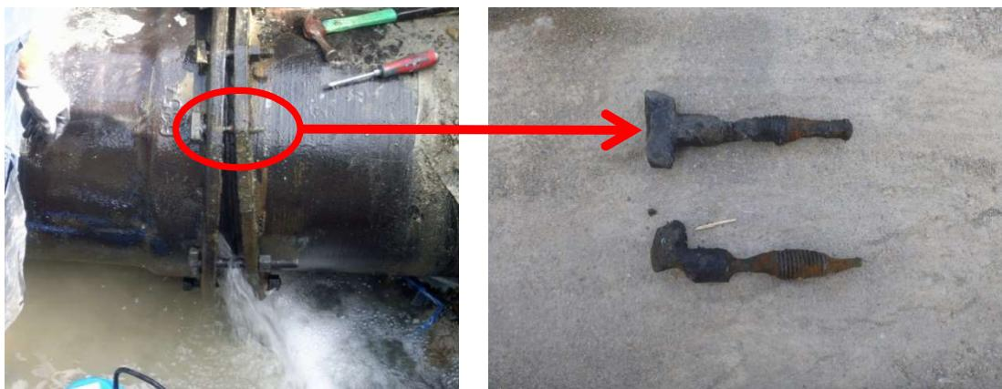
写真 3-2 【ボルト腐食による管継手からの漏水状況（左）と腐食したボルト（右）】
