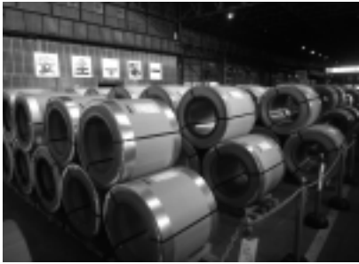
↑カラー鋼板 生産量は多いときで一日あたり150 t（一般住宅の屋根300～400戸分） にもなります。
