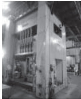
巨大な油圧式プレス機。車両用信号機カバーを製造している。
