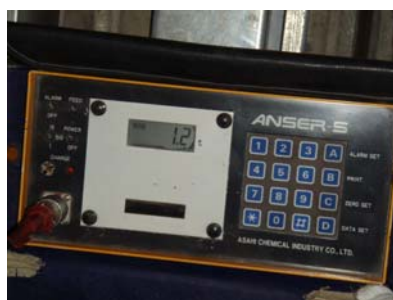
写真 - 2.1.8 アンカー引抜試験 ( 2 )
