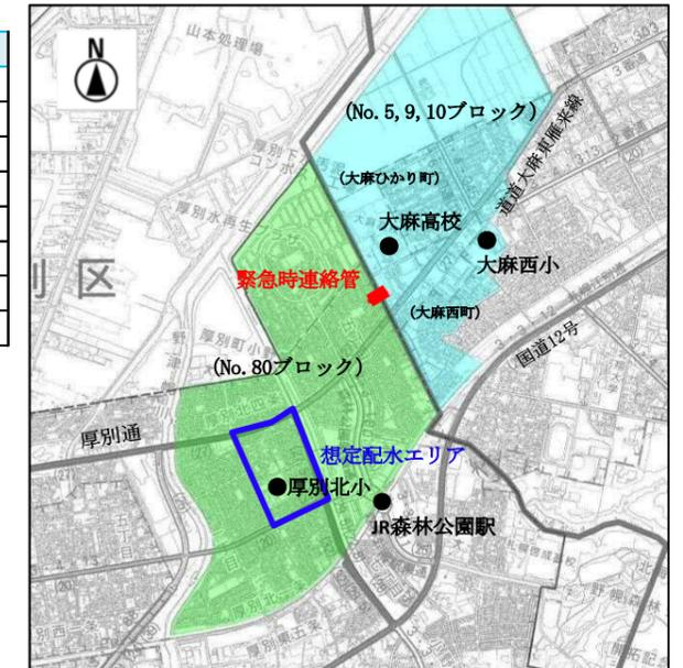
図4 緊急時連絡管整備位置と想定配水エリア
