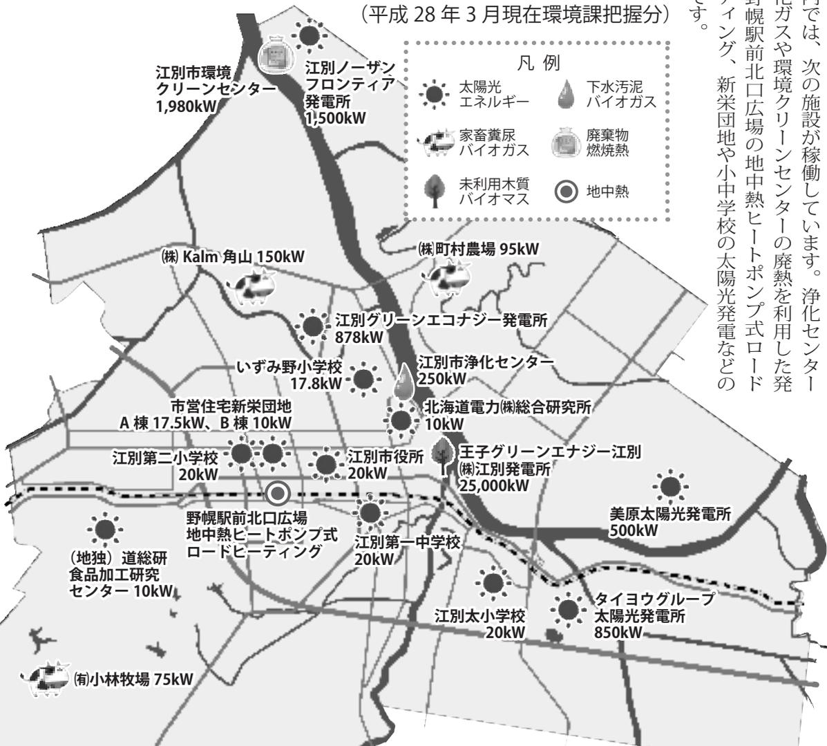
民間事業者の取り組みとしては、環境クリーンセンターや環境事務所の市有地2か所で大規模太陽光発電所が稼働しているほか、酪農業者のバイオガス発電、間伐材を燃料とする木質バイオマス発電所も稼働しています。これらの総発電量の見込みは、約166ギガワット時。市全体の一般家庭の約80%にあたる約4万4000世帯の年間の消費電力量に相当します。
