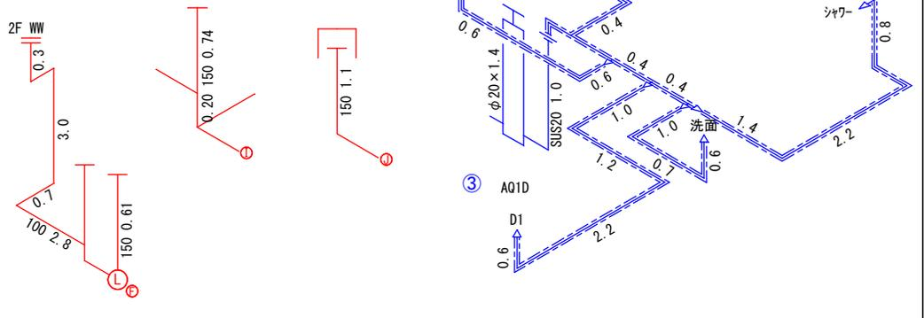
排水管：屋内及び屋外配管寸法が0.4m以下の場合省略可。
