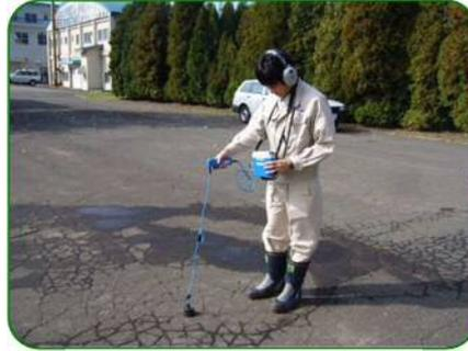
【漏水調査（漏水探知機）】
