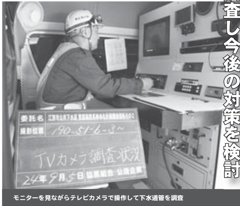
モニターを見ながらテレビカメラで操作して下水道管を調査
