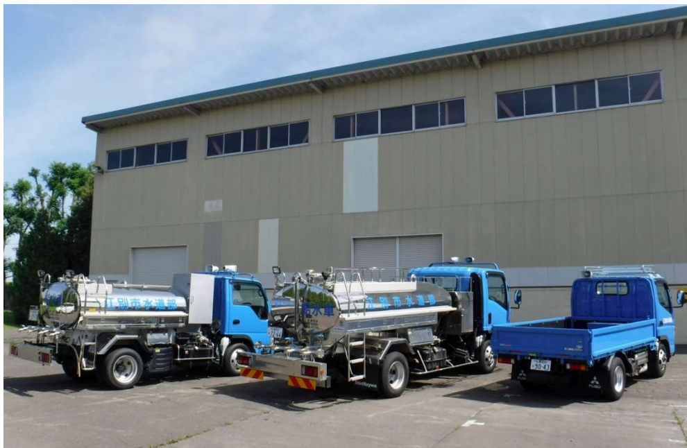
写真 3-8 【加圧給水タンク車等】
