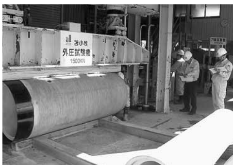
下水管の強度試験
