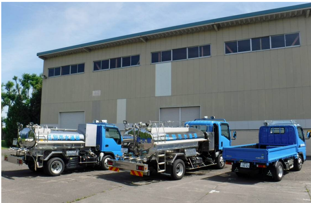
写真 3-8 【加圧給水タンク車等】
