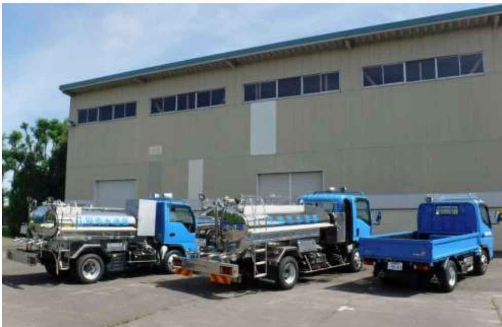
写真 3-8 【加圧給水タンク車等】
