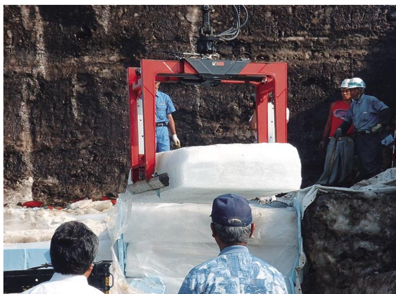
民間企業による雪氷ブロックの保存状態確認と搬出実験
